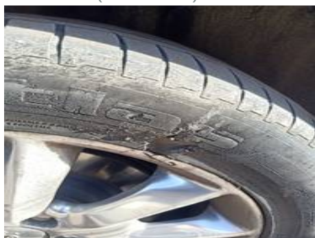
Pneu arrière droit (Usure 75%)
