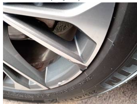
Jante alliage arrière droite (Rayure)
