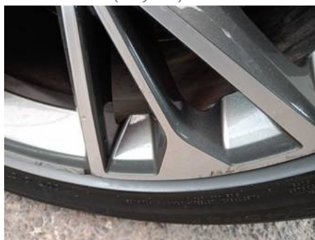
Jante alliage avant droite (Rayure)
