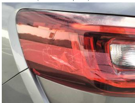
Phare arrière gauche (Défaut aspect)
