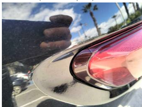
Phare arrière gauche (Défaut aspect)
